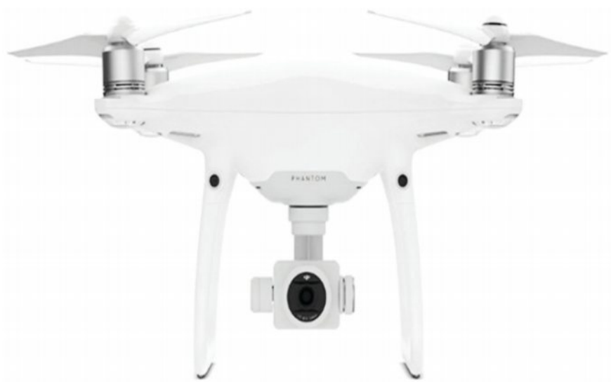
Sáng kiến sử dụng Flycam Phantom 4 PRO V2.0, kiểm tra ĐZ điện trên không 220-500 kV, góp phần giảm nhiều nhân công kiểm tra ĐZ điện, ghi nhận hình ảnh chính xác, rõ ràng
