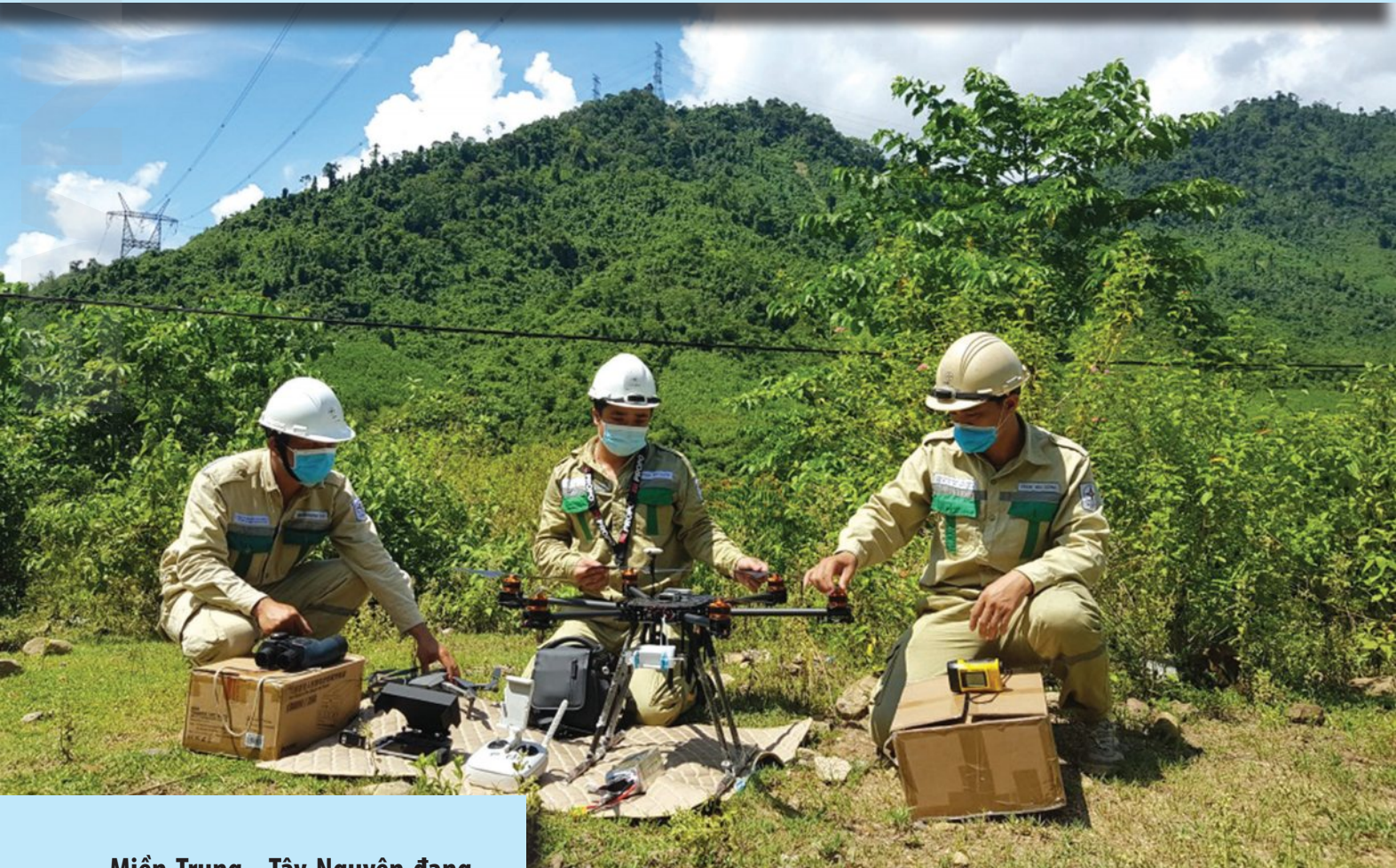
PTC2 sử dụng thiết bị bay (UAV) kiểm tra đường dây 500kV
