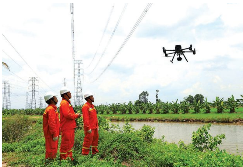
Sử dụng flycam trong quản lý vận hành đường dây
